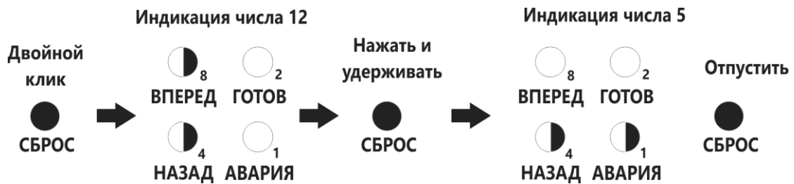
Рисунок 8 Пример индикации тока 125%
