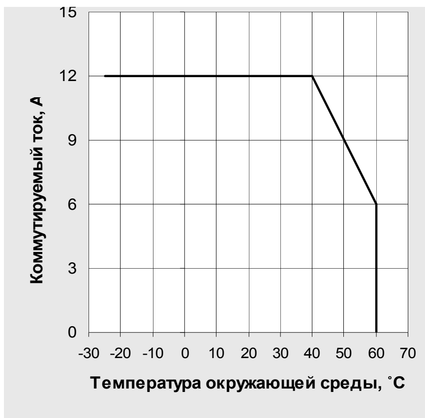
Рисунок 1 - Зависимость коммутируемого тока от температуры окружающей среды (При продолжительном режиме работы).
