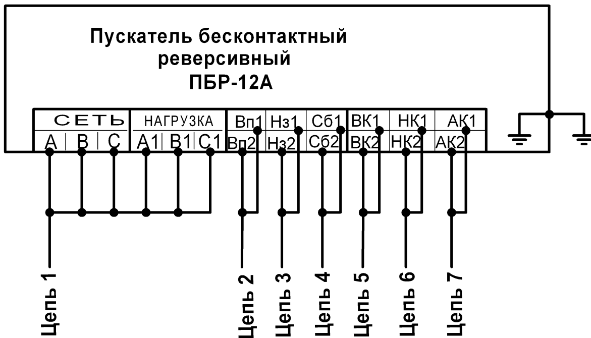
Рисунок 5 - Установка перемычек и маркировка цепей при измерении сопротивления изоляции
